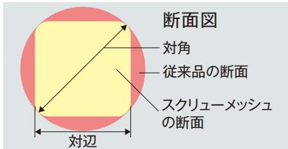
従来のワイヤーメッシュは丸鋼（断面が円形の鉄線）を使用しておりますが、スクリーメッシュは断面が四角形の鉄線を使用しており、図の赤い部分の材料が削減されています。
