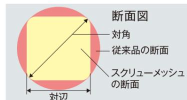
従来のワイヤーメッシュは丸鋼(断面が円形の鉄線)を使用しておりますが、スクリューメッシュは断面が四角形の鉄線を使用しており、図の赤い部分の材料が削減されています。
